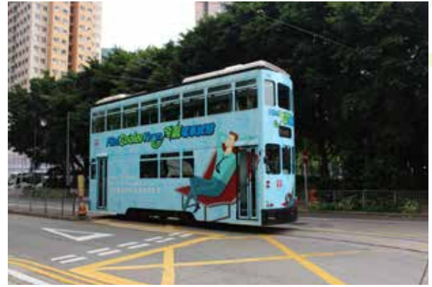
於屈地街電車廠內製造的首架試行冷氣電車 88 號，配備空調系統，此系統亦可轉換成普通的通風系統。
